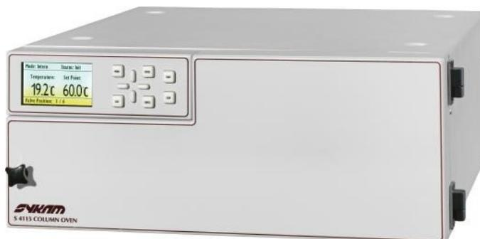
Il modello LS 4115 Column Oven è un termostato a riscaldamento per contatto, così da garantire la miglior stabilità ed accuratezza della temperatura. La colonna è installata all'interno del Column Oven, in un holder che incorpora tutta la colonna per assicurare il miglior trasferimento di calore. La versione standard assicura temperature stabili tra +30°C e 100°C con un'accuratezza di 0,1°C.
