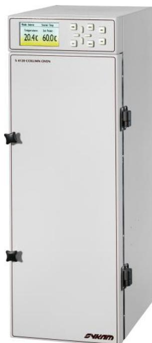
Il modello LS 4120 Column Oven è un termostato a riscaldamento per contatto, così da garantire la miglior stabilità ed accuratezza della temperatura. La colonna è installata all'interno del Column Oven, in un holder che incorpora tutta la colonna per assicurare il miglior trasferimento di calore. La versione standard assicura temperature stabili tra +30°C e 150°C con un'accuratezza di 0,1°C.
