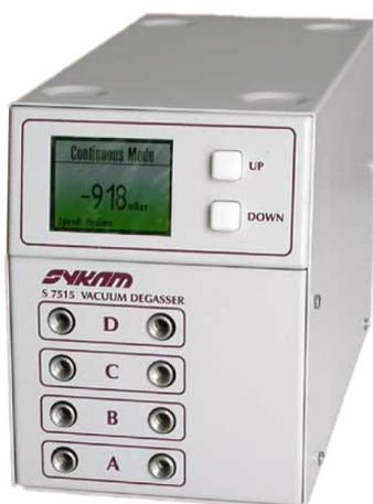
Il Vacuum Degasser S 7515 è un sistema di degassaggio ad alta efficienza. I gas disciolti sono rimossi dal solvente grazie al vuoto applicato ad una membrana semipermeabile.
